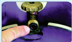
Sprawdź, czy przy wylocie zaworu znajduje się gumowa uszczelka, a jej stan techniczny nie budzi wątpliwości
