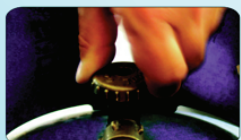
Odkręć zawór butli powoli wystarczy jeden obrót. Nie odkręcaj zaworu do oporu, gdyż możesz go uszkodzić. Staraj się zakręcać zawór butli, gdy butla nie jest używana
